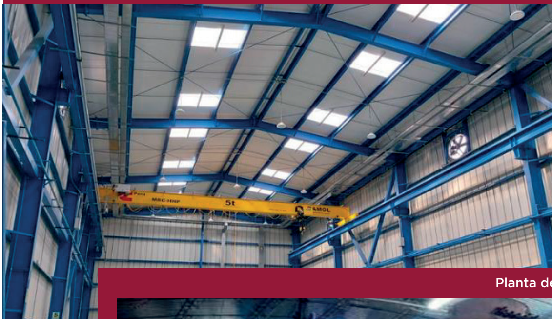
Techo Con Puente Grúa De 5tn - Komatsu Mitsui
